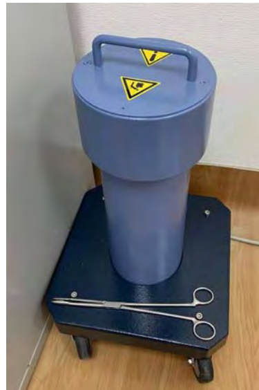
后装治疗机专用应急贮存罐和长柄工具
